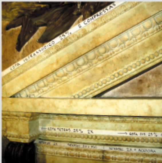
Vista dos diferentes testes de limpeza para aprovação da fiscalização do Iphan e Sedrephac.
